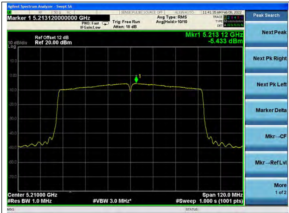
(Channel 42, 5210MHz, 802.11ac (VHT80))
