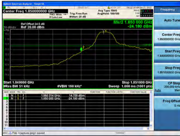
Band2 / 5MHz / High CH / QPSK / 1 RB
