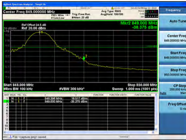
Band26 / 10MHz / High CH / QPSK / 1 RB
