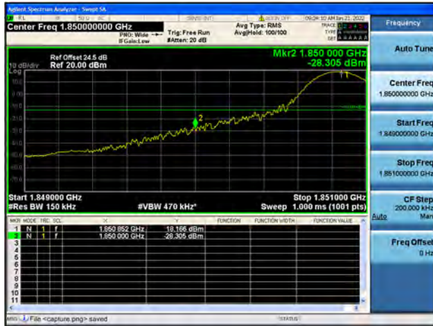
Band2 / 15MHz / High CH / QPSK / 1 RB
