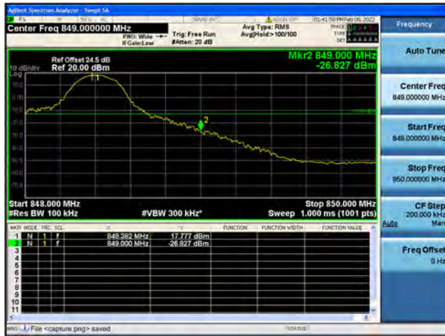
Band5 / 10MHz / High CH / QPSK / 1 RB
