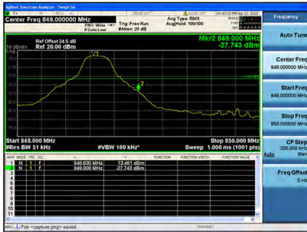
Band26 / 5MHz / High CH / QPSK / 1 RB
