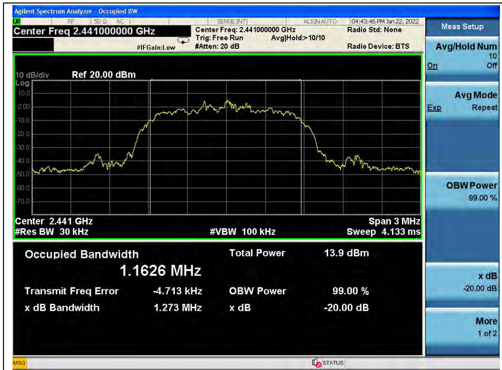
(Channel 39, \pi/4 -DQPSK)
