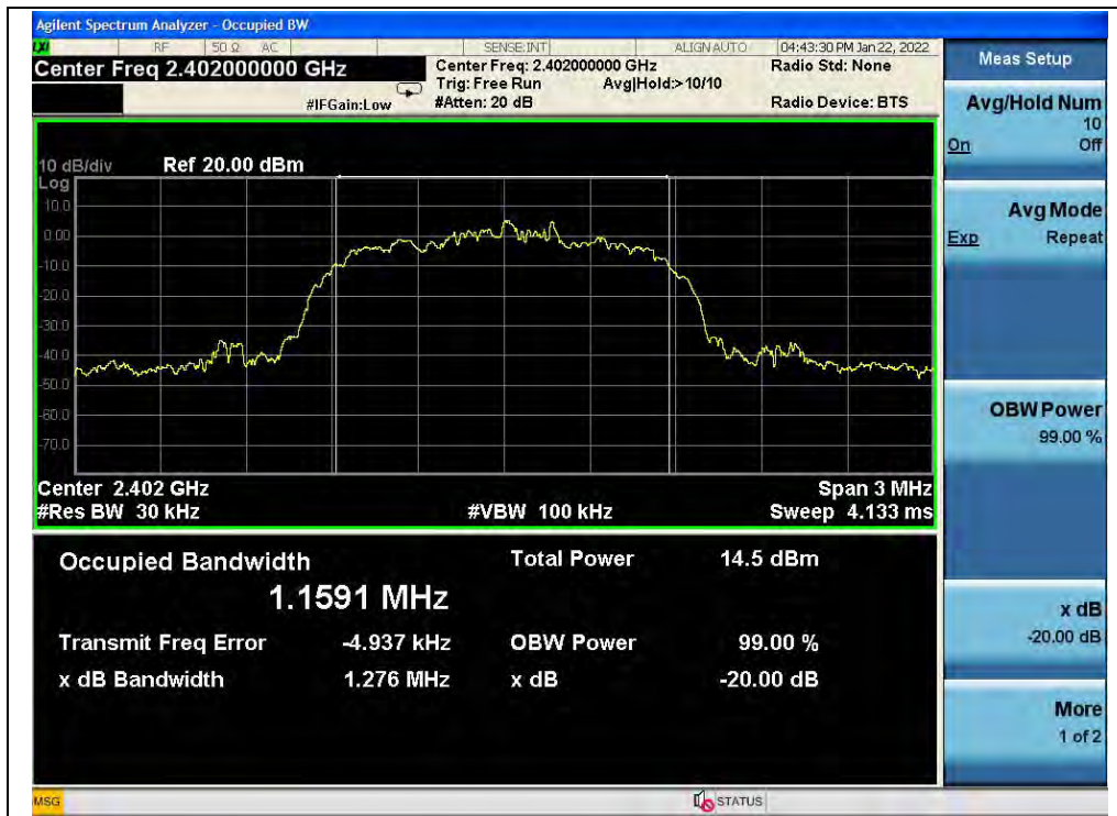
(Channel 0, \pi/4 -DQPSK)
