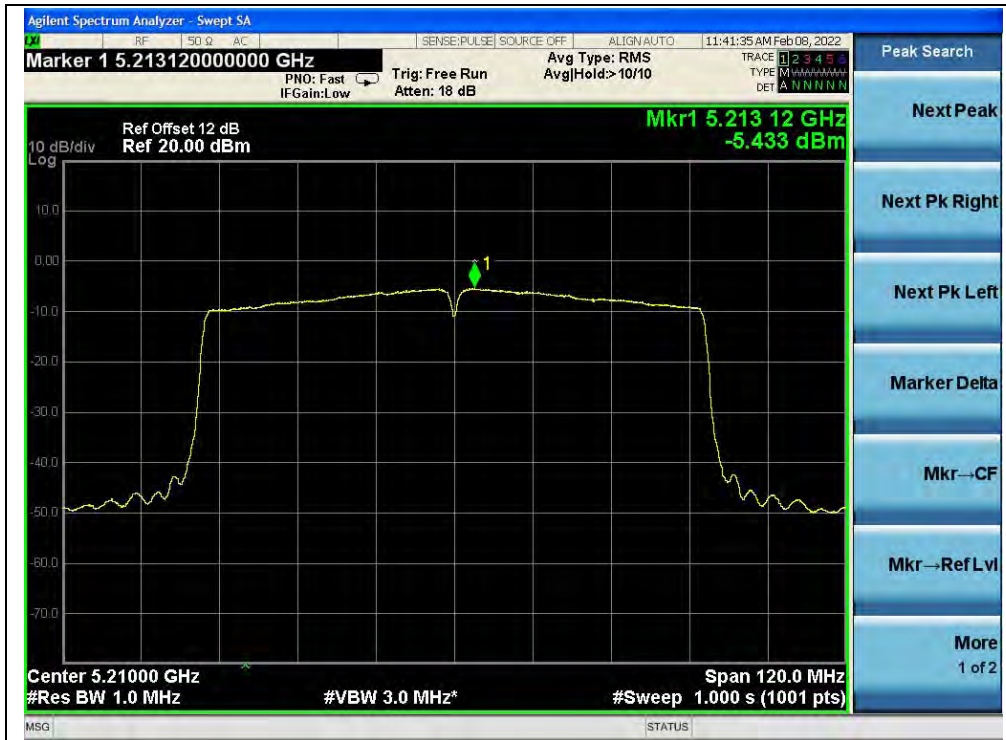
(Channel 42, 5210MHz, 802.11ac (VHT80))
