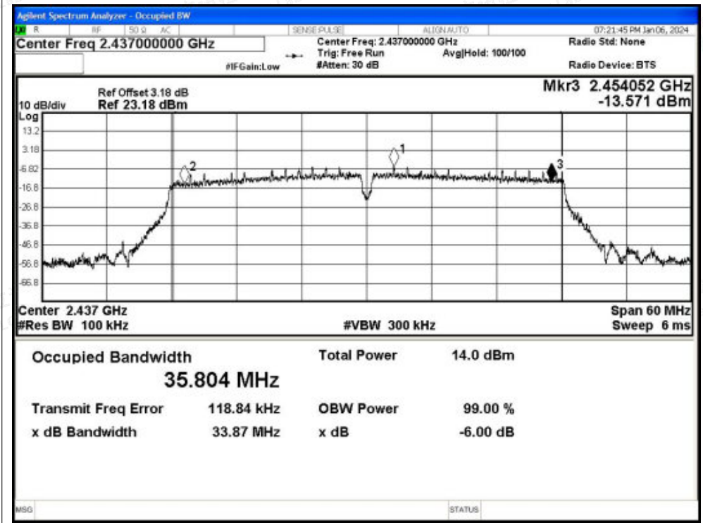
-6dB Bandwidth NVNT n40 2452MHz Ant1
