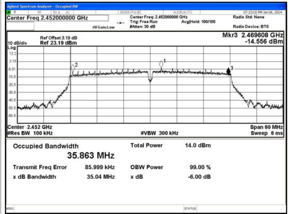
-6dB Bandwidth NVNT n40 2452MHz Ant1
