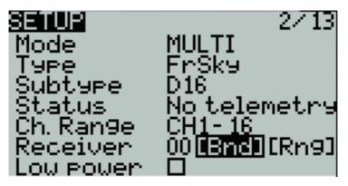
·请长按MDL按钮进入模型设置,在SETUP页面中选择MULTI,并在子选项中选择需要使用的协议。系统根据 您选择的射频协议,会自动开启对应的射频模块,同时关闭其它三个射频模块。系统在同一时间只会开启一个 射频模块,以确保没有多余的无线电信号相互干扰。
