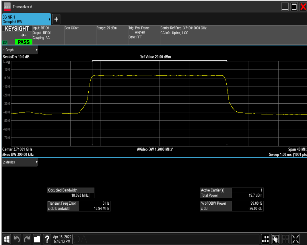
n78(3700-3800) SCS=30kHz DFT_QPSK BW=20MHz Channel=647334 RB=50@0
