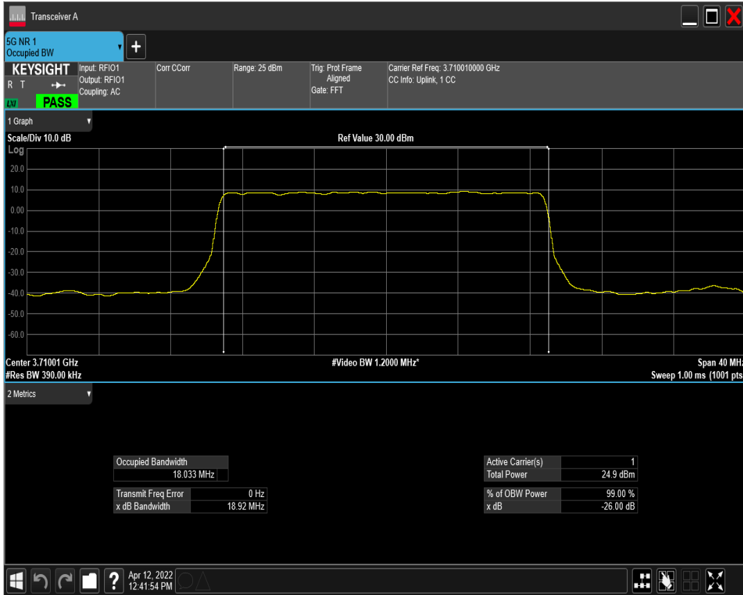
n77(3700-3980) SCS=30kHz DFT_QPSK BW=20MHz Channel=647334 RB=50@0
