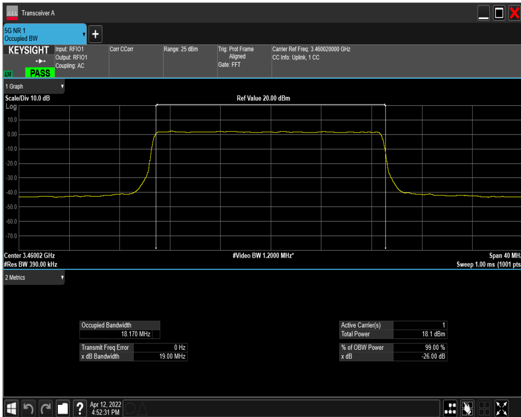
n77(3450-3550) SCS=30kHz DFT_QAM16 BW=20MHz Channel=630668 RB=50@0
