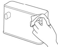
Reinigen Sie den Signalübertragungsbereich der Ladestation (es wird empfohlen, diesen einmal im Monat zu reinigen)
