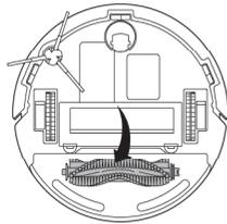
3. Verwenden Sie die passende Reinigungsbürste, um den Staub von der Hauptbürste und der Hauptbürstenkammer zu fegen, und reinigen Sie dann die Verwicklungen auf der Hauptbürste.
