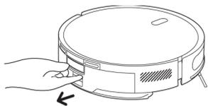
2. Den Staubbehälter öffnen und den Müll entleeren.
