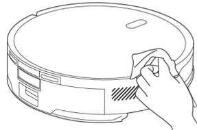
Reinigen Sie die Ladekontakte der Haupteinheit
