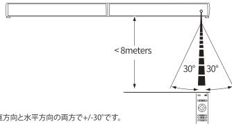
リモコンの作動範囲は、垂直方向と水平方向の両方で+/-30°です。
