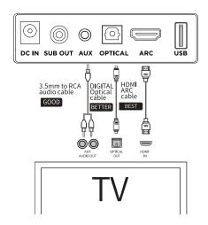
ケーブルを接続したら、リモコンまたはサウンドバーのボタンを使用して入力を変更します。
