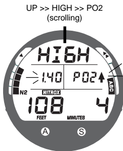
Fig. 65 - High PO2 Alarm Main
