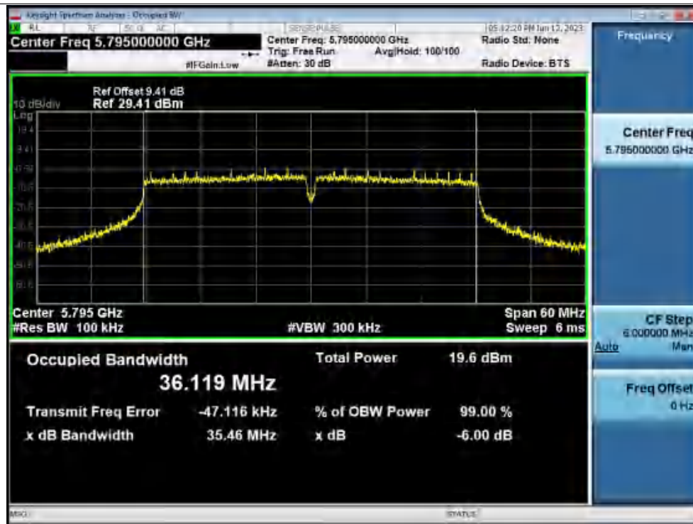
-6dB Bandwidth NVNT n40 5795MHz Ant1
