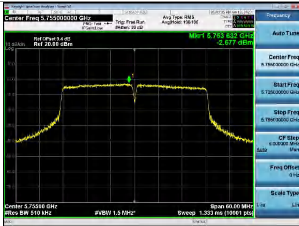
PSD NVNT n40 5795MHz Ant1
