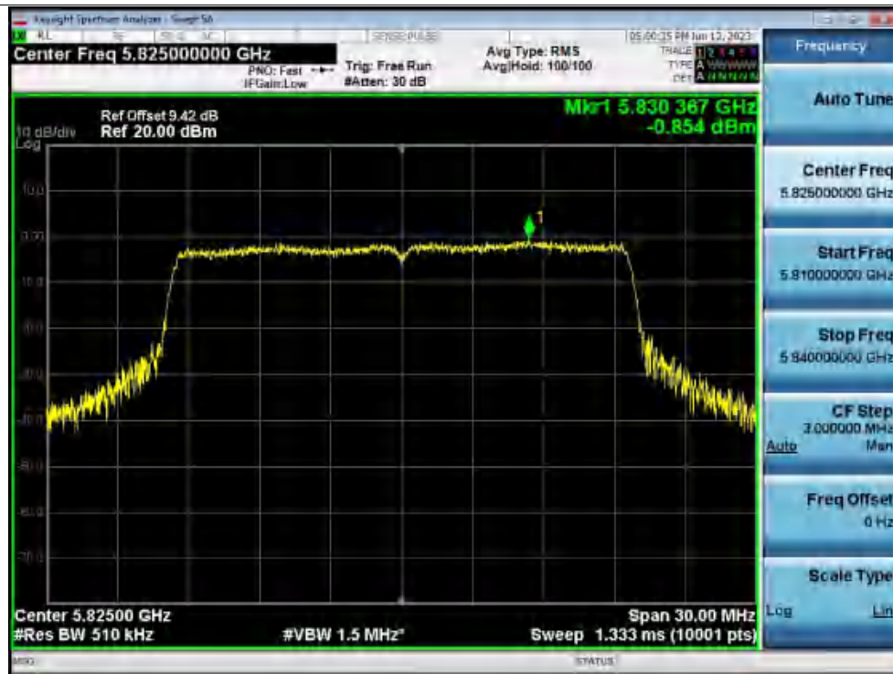
PSD NVNT ax40 5755MHz Ant1
