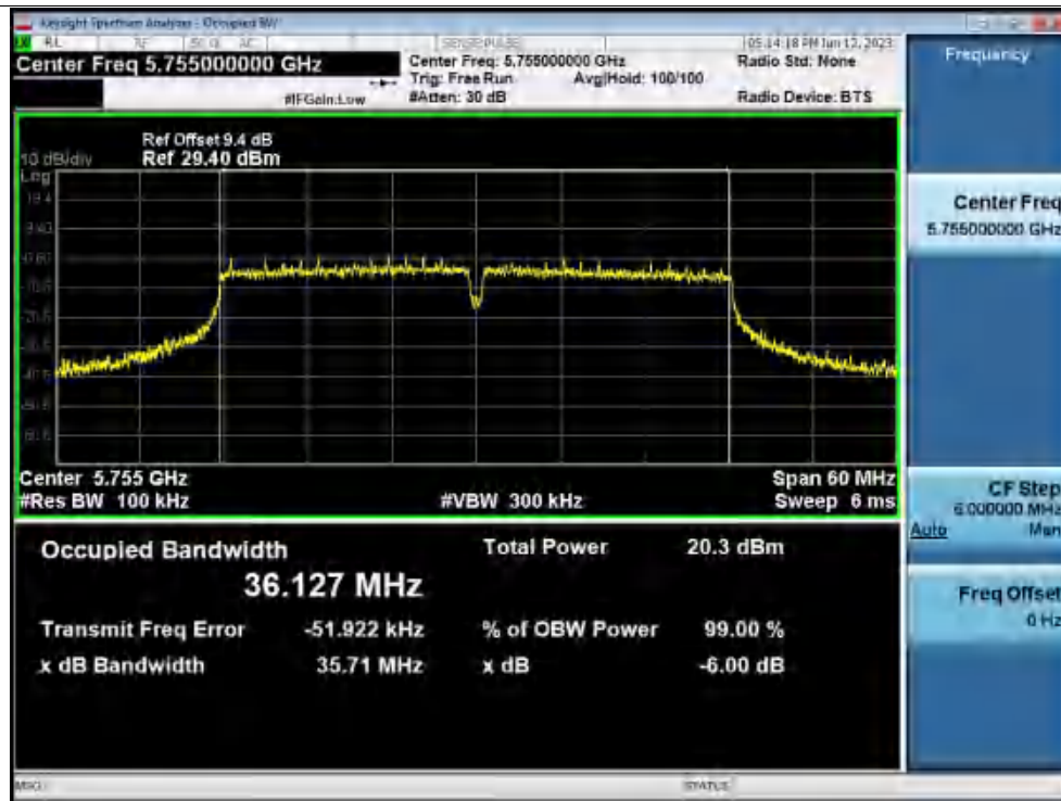
-6dB Bandwidth NVNT ac40 5755MHz Ant1
