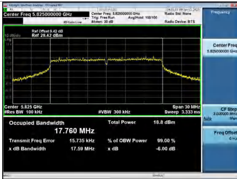
-6dB Bandwidth NVNT ac40 5755MHz Ant1
