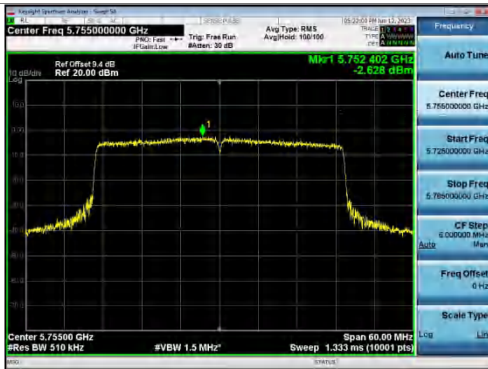
PSD NVNT ax40 5755MHz Ant1
