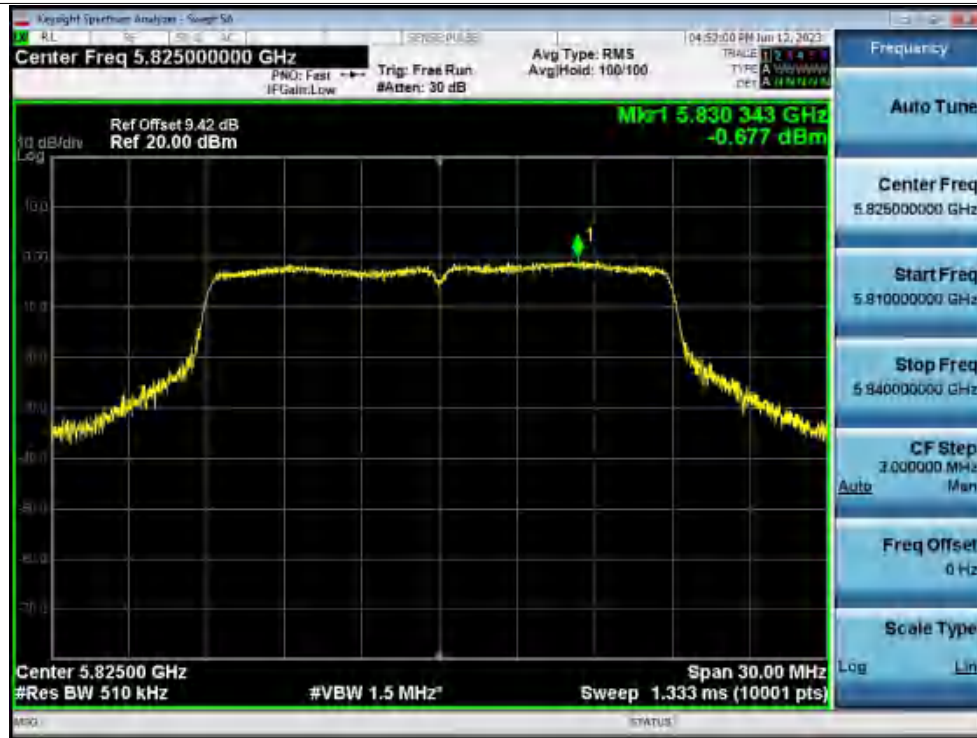
PSD NVNT ac40 5755MHz Ant1
