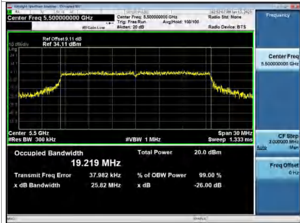
-26dB Bandwidth NVNT ax20 5700MHz Ant1
