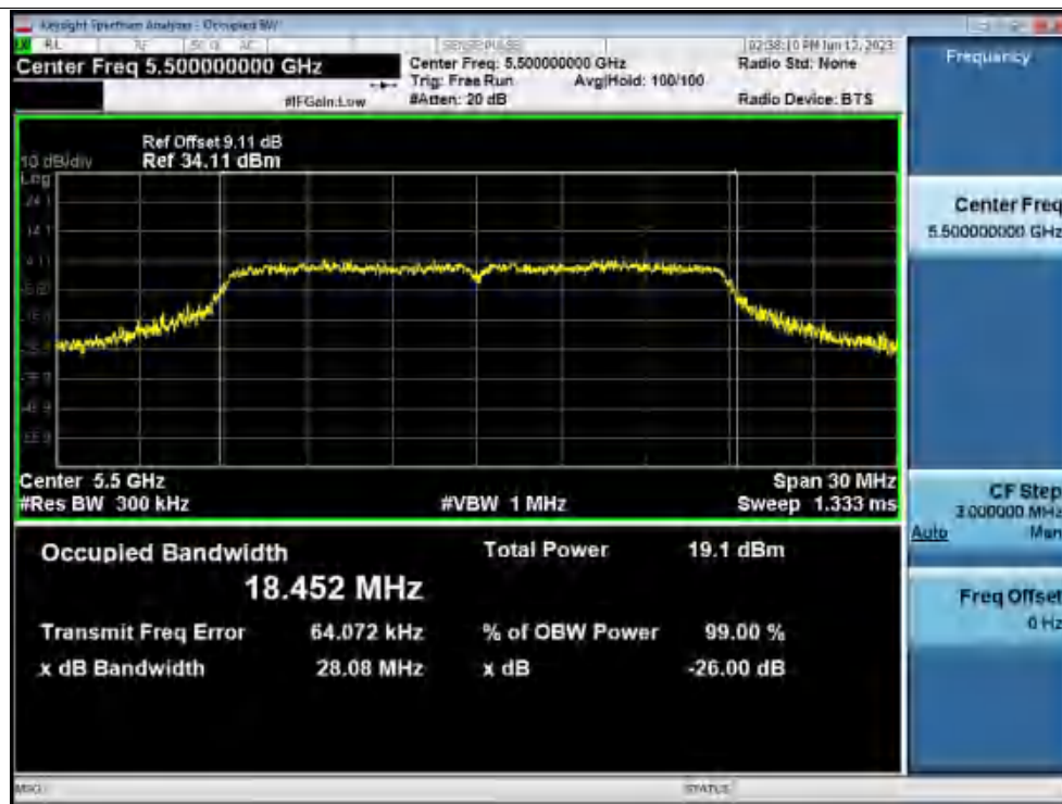
-26dB Bandwidth NVNT ac20 5500MHz Ant1
