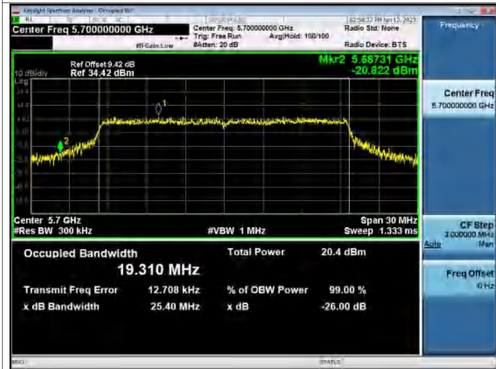
-26dB Bandwidth NVNT ax20 5700MHz Ant1
