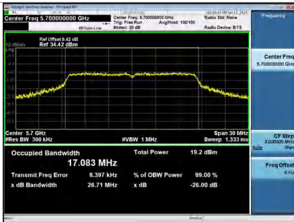
-26dB Bandwidth NVNT a 5700MHz Ant1
