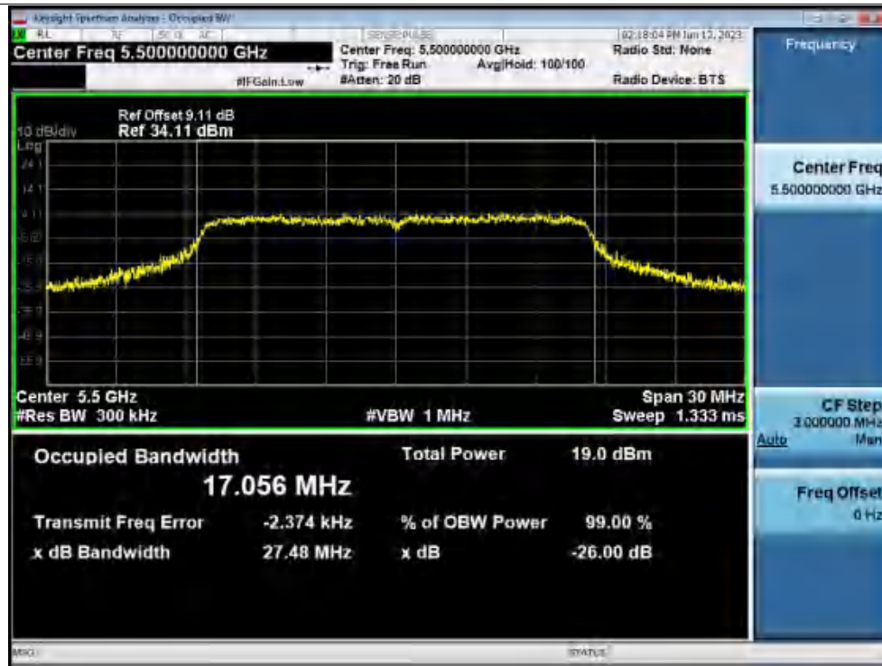
-26dB Bandwidth NVNT a 5700MHz Ant1
