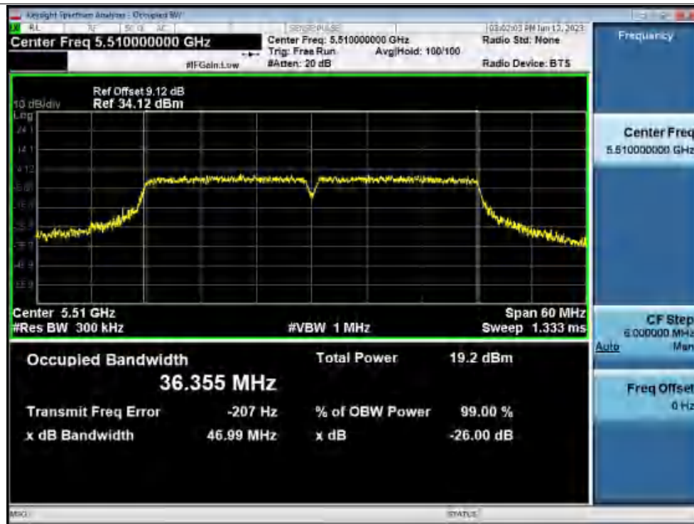
-26dB Bandwidth NVNT n40 5590MHz Ant1
