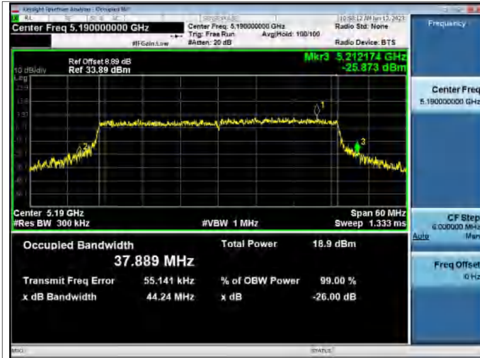
-26dB Bandwidth NVNT ax40 5230MHz Ant1
