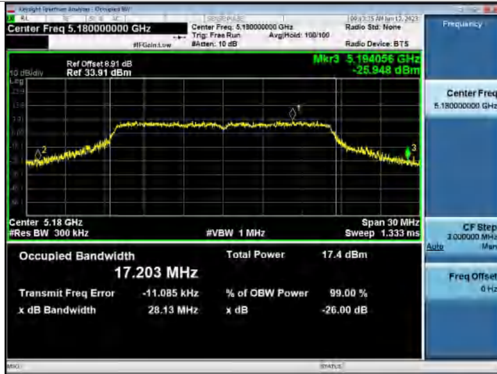
-26dB Bandwidth NVNT a 5200MHz Ant1
