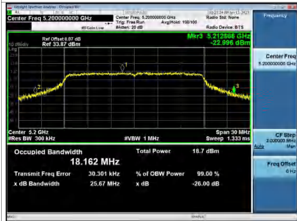
-26dB Bandwidth NVNT ac20 5200MHz Ant1
