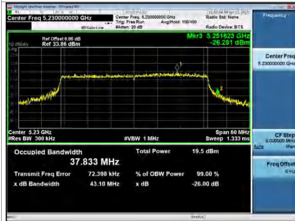
-26dB Bandwidth NVNT ax40 5230MHz Ant1
