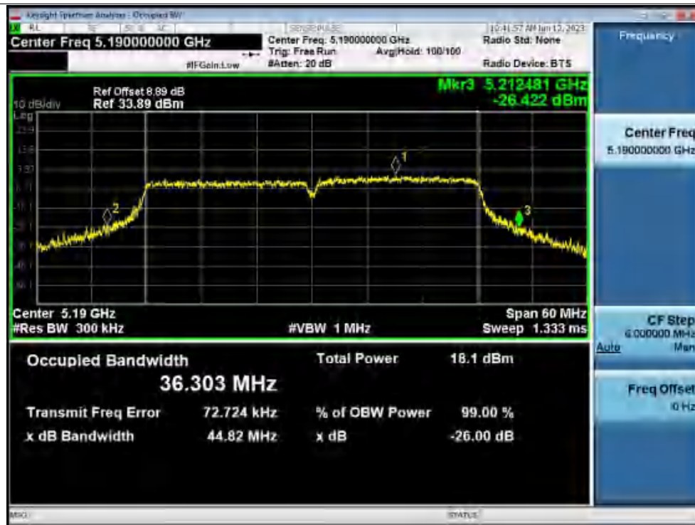
-26dB Bandwidth NVNT n40 5230MHz Ant1
