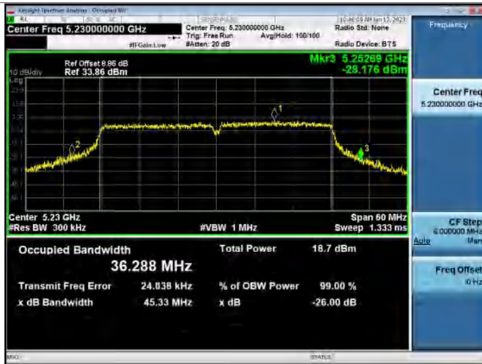
-26dB Bandwidth NVNT n40 5230MHz Ant1
