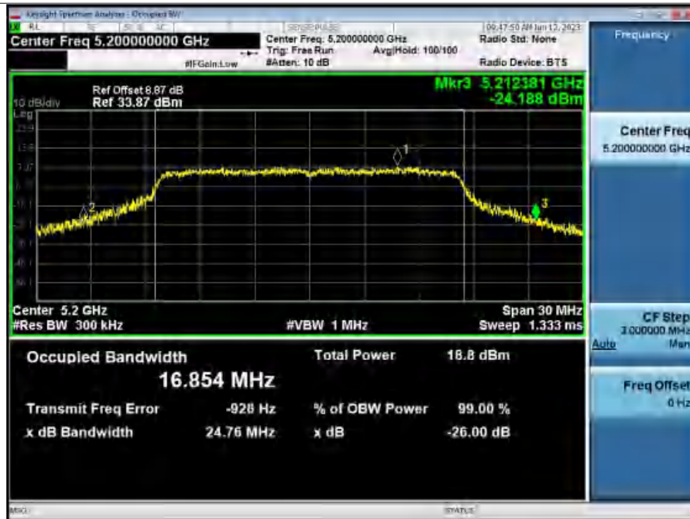
-26dB Bandwidth NVNT a 5200MHz Ant1
