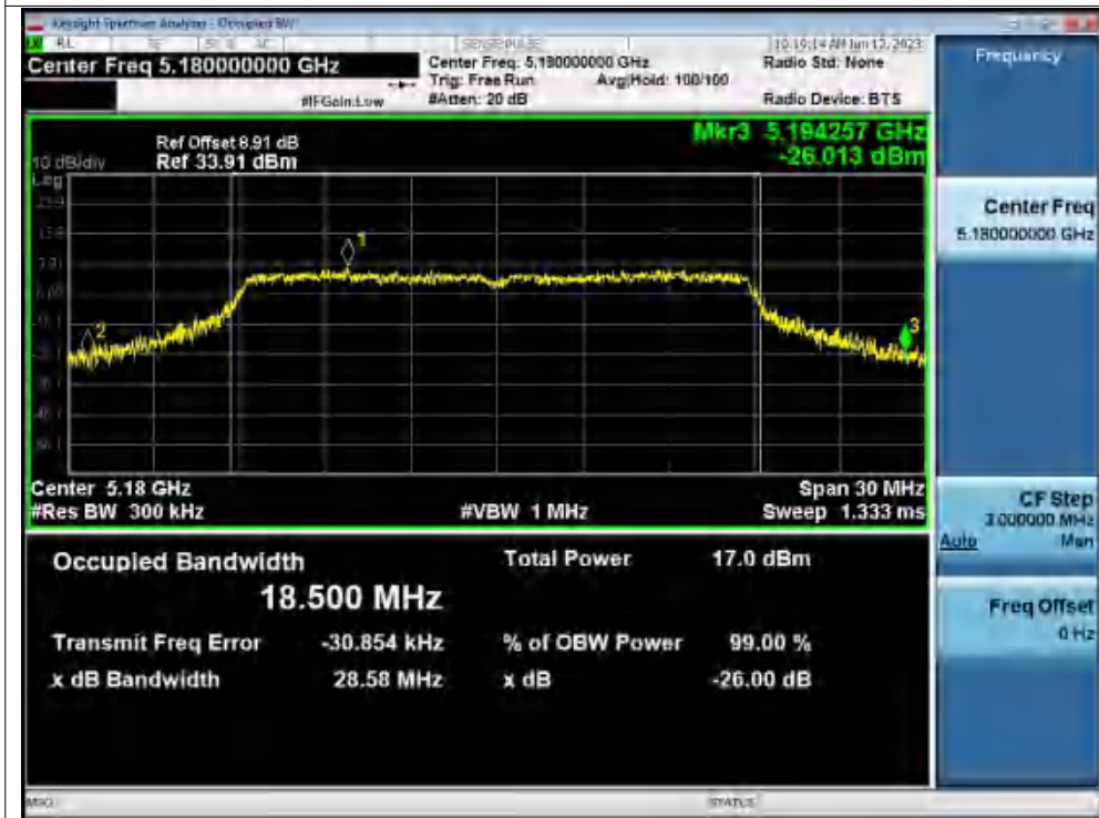
-26dB Bandwidth NVNT ac20 5200MHz Ant1
