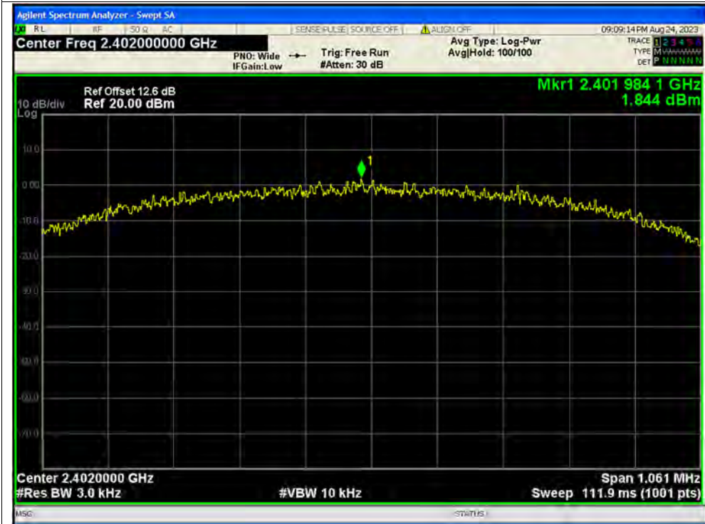
PSD NVNT BLE 1M 2440MHz Ant1
