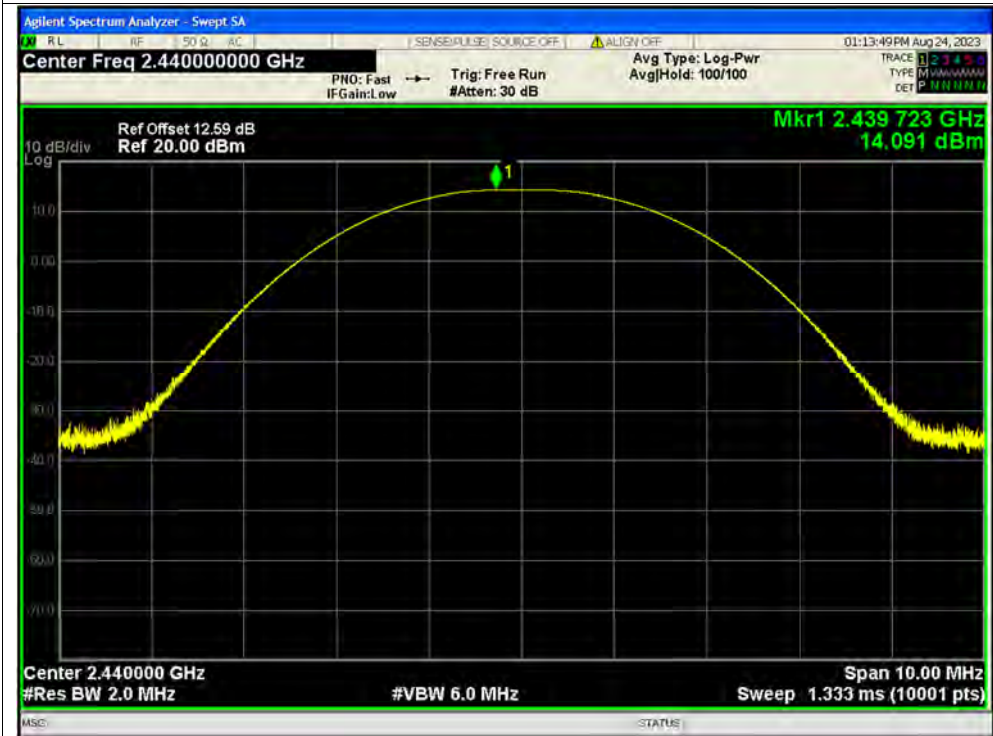
Peak Power NVNT BLE 1M 2440MHz Ant1
