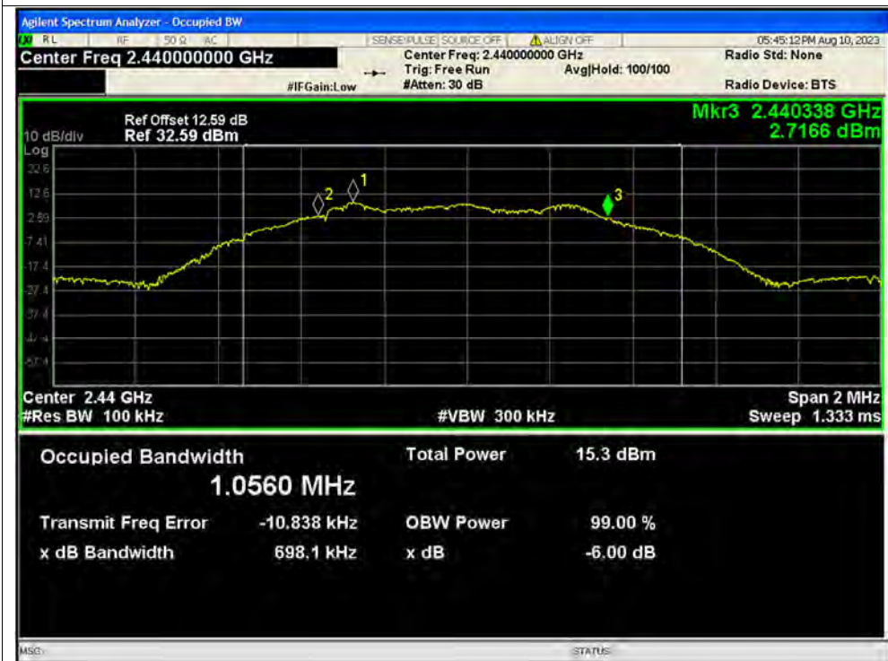
-6dB Bandwidth NVNT BLE 1M 2440MHz Ant1
