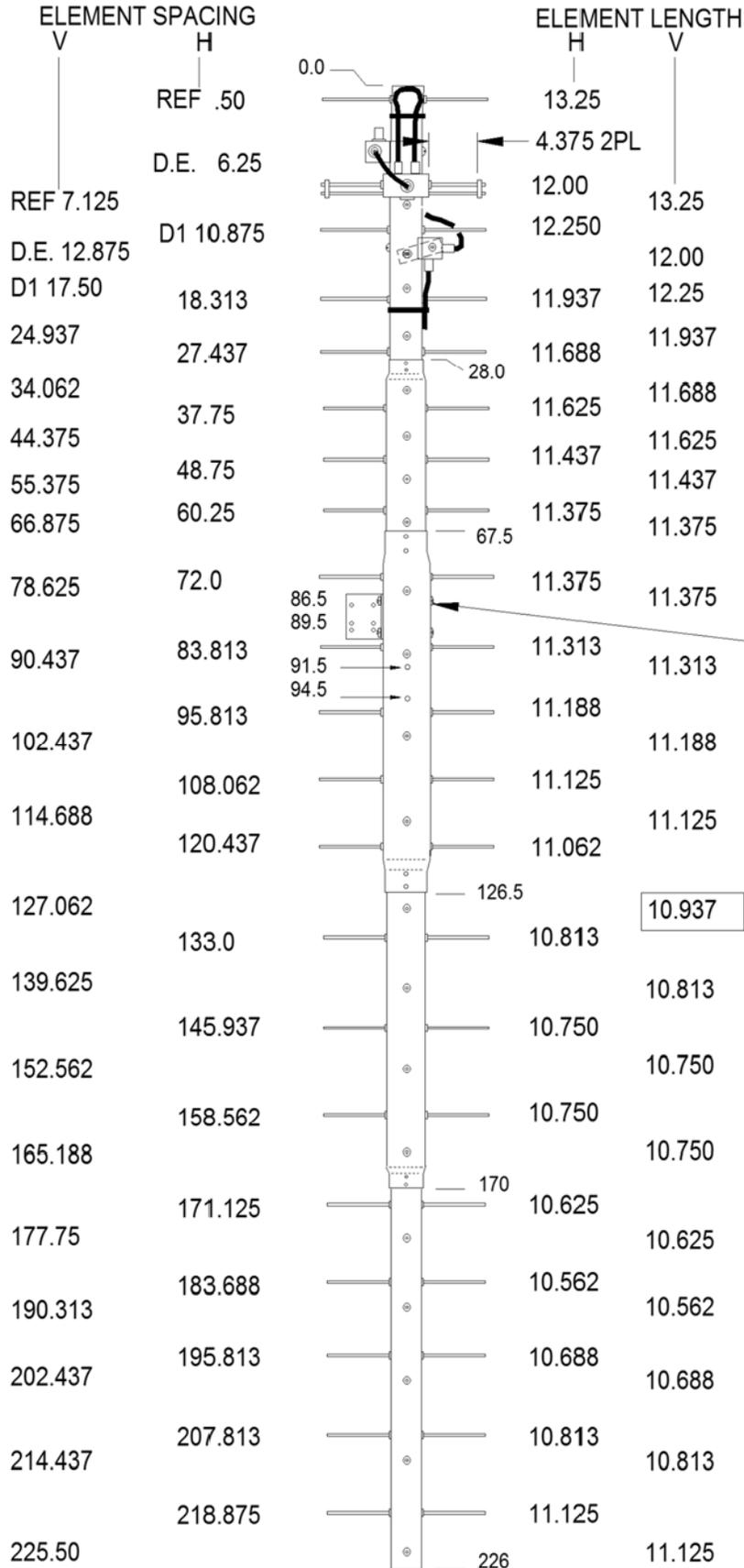
DRIVEN ELEMENT BLOCKS SHOWN POSITIONED FOR RIGHT HAND CIRCULARITY
