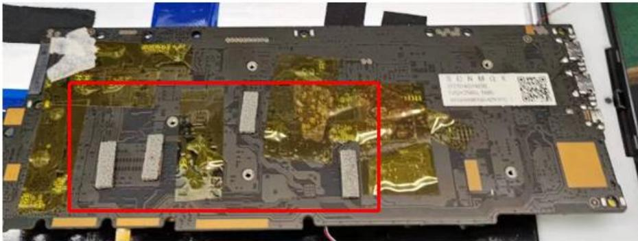
主板漏铜区域处需要用导电泡棉做接地处理。
