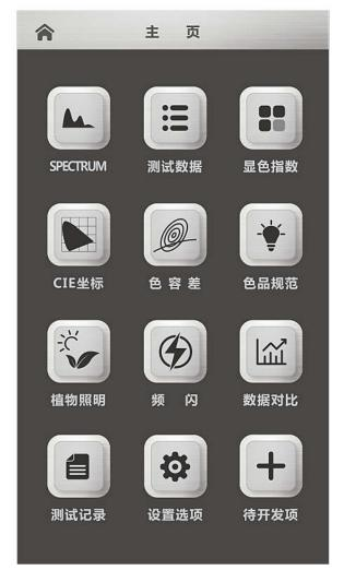
選擇測量項目後會跳轉到對應的測量頁面,然後點擊測量頁面右下角測量按鍵,儀器開始測量,待頁面下方的進圖條全部顯示為藍色,表示測量完成,界面上顯示測試結果。您也可以通過左右翻頁查看不同的測量項目。測量過程中,也可按下暫停按鍵結束測量。
